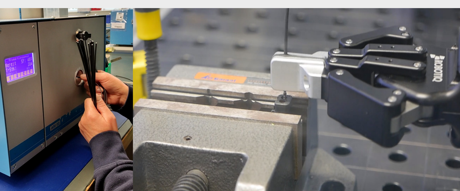
Manuelle Bedienung von Kabelkonfektionsmaschinen (links) und automatisierte Ausführung (rechts).
